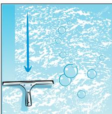
Comience con el jalador realizando un corte en la orilla de la ventana hacia la parte baja. Coloque el jalador en la orilla y jale hacia abajo traslapando el hule unos dos centímetros.
