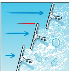
También se puede comenzar por la parte superior y de forma horizontal pasar el jalador traslapando dos centímetros. Cuando separe el jalador del vidrio es necesario secarlo con un trapo que no deje pelusa antes de volver a pegarlo al vidrio. Para terminar, limpie las orillas con el trapo.
